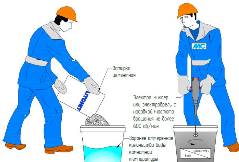
Рис. 37. Приготовление состава
